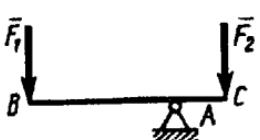
На брус  $BC$ , закрепленный в шарнире  $A$ , действуют вертикальные силы  $F_1 = 4$  кН и  $F_2$ . Определить силу  $F_2$  в кН, необходимую для того, чтобы брус в положении равновесия был горизонтальным, если расстояния  $AC = 2$  м,  $AB = 6$  м. (12,0)
